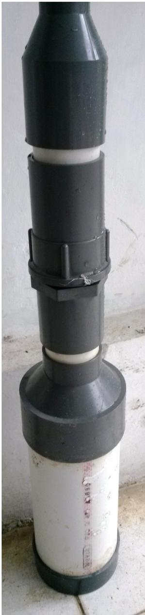
Lampiran 4. Gambar *swing valve* (klep tabok) yang digunakan.
