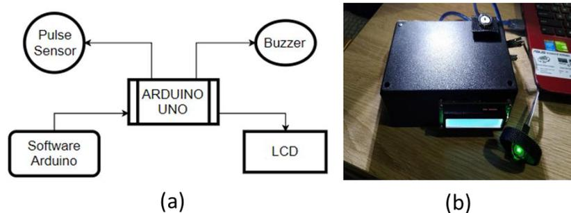
**GAMBAR 1.** Alat pendeteksi detak jantung yang dihasilkan: (a) Diagram blok (b) Bentuk fisik
