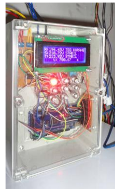
Gambar 4. Monitoring Tegangan Kurang Pada Fasa R
