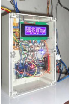
Gambar 5. Monitoring Tegangan Turun Temporer Pada Fasa S dan Tegangan Turun Sesaat Pada Fasa T.
