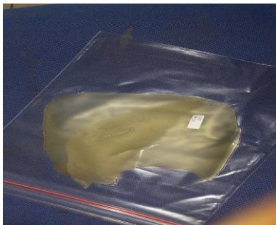
Gambar 2b. Bioplastik dengan formulasi pati-gelatin 5,5 : 4,5 (g/g) dan MFC 1%
