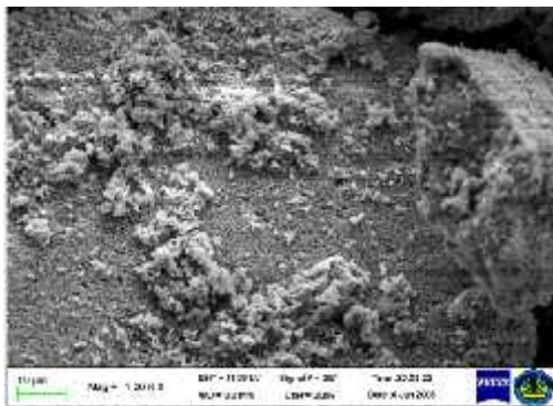
Gambar 4. Data SEM serbuk HA yang di sinter pada temperatur 600^\circ\text{C} selama 2 jam.
