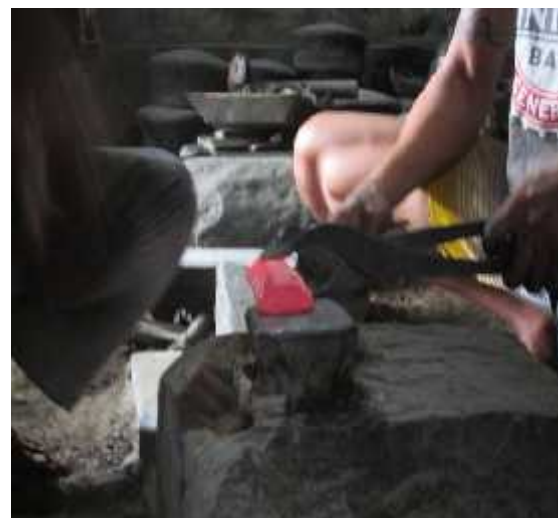
Gambar 2. Proses penempaan manual
