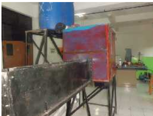
Gambar 6. Rancangan sistem pengujian model turbin helik.
