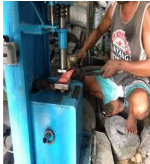
Gambar 4 Alat dan proses tempa mekanik
