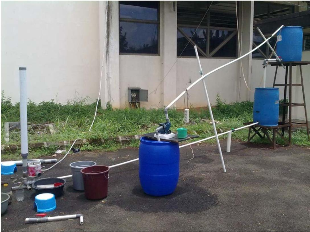
Gambar 4. Model pompa tanpa motor (*hydrum pump*) yang dirancang.
