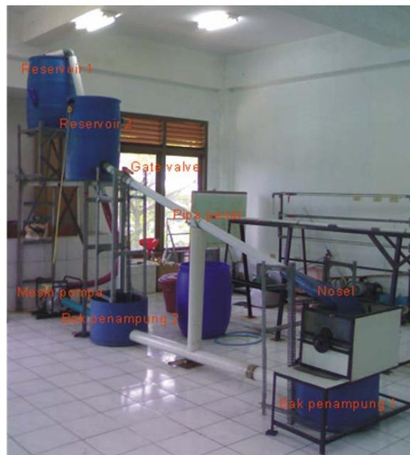
Gambar 9. Model sistem pembangkit listrik yang dirancang.
