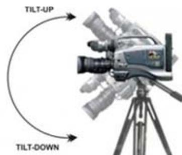
Gambar 2. Pergerakan *Tilting* Kamera<sup>[6]</sup>
