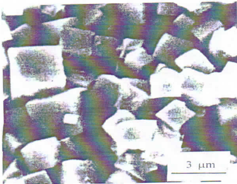
Gambar 7. Fotograf SEM dari LaCrO_3 yang dipreparasi dengan teknik hidrothermal (Zheng et al. , 1999)
