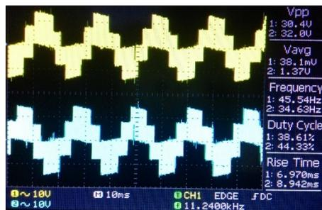
Gambar 5. Tampilan gelombang keluaran inverter frekuensi 45 Hz
