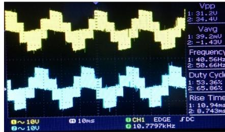
Gambar 4. Tampilan gelombang keluaran inverter frekuensi 40 Hz
