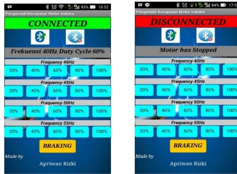
Gambar 3. Tampilan aplikasi pada layar *smartphone* saat terhubung dan tidak terhubung dengan *Bluetooth*
