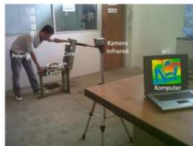
Gambar 1. Set-up eksperimen interaksi *man-machine*
