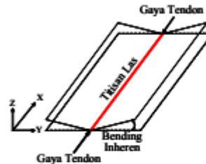
Gambar 3. Gaya Tendon pada Pengelasan
