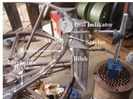
Gambar 11. Set-up Pengukuran Distorsi Radial dan Aksial Roda Traktor
