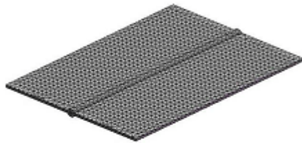
Gambar 5. Meshing Model Pengelasan Tumpul
