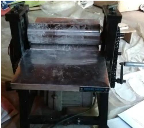
Gambar 6. Alat Press Opak Singkong Menggunakan Motor Listrik AC
