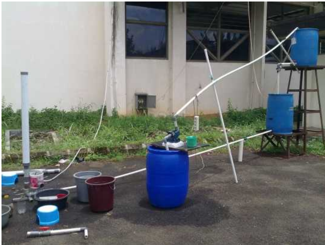
Gambar 4. Model pompa tanpa motor ( hydram pump ) yang dirancang.
