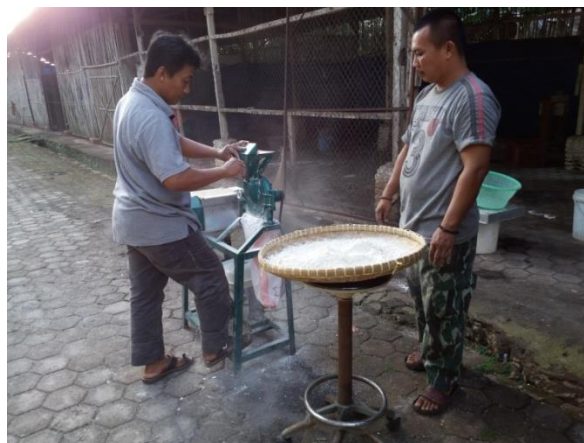
Gambar 10. Alat penggilingan ampas cassava dan tapioka
