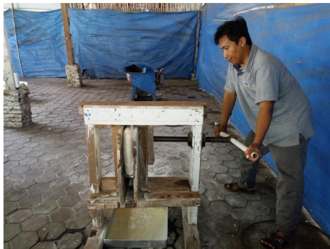
Gambar 8. Proses pengepresan ampas cassava
