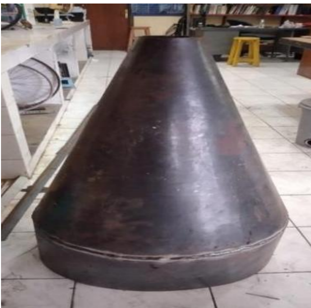
Gambar 8. Basin berbentuk kerucut yang dibuat.
