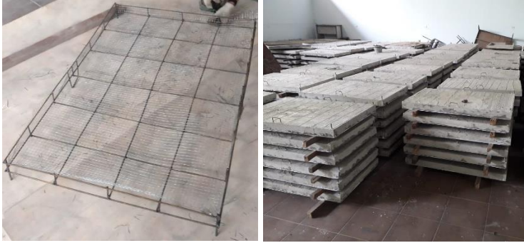
Gambar 20. Kerangka panel ferosemen dan hasil pabrikasi
