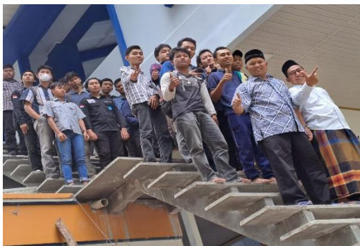
Gambar 28. Uji coba beban di atas tangga ferosemen
