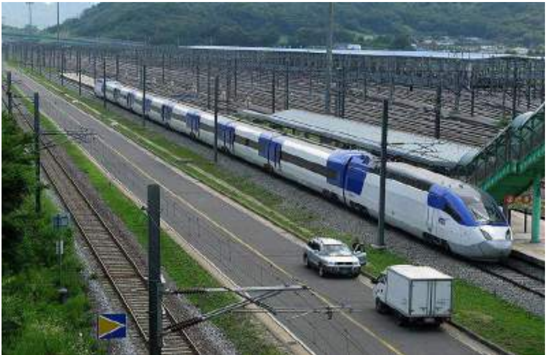
Gambar 3. 10 Kereta cepat seri KTX Sancheon yang dikembangkan Hyundai Rotem dengan mengadaptasi teknologi TGV Perancis. Kandungan lokal meningkat dari 58% menjadi 87% dari seri sebelumnya mengindikasikan
