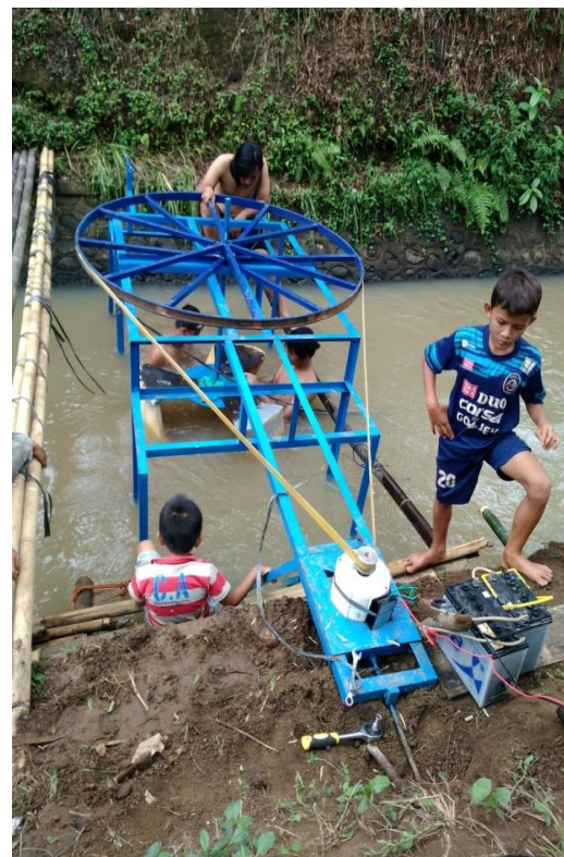
Gambar 4. Pengujian model sistem pembangkit listrik di saluran irigasi Way Tebu
