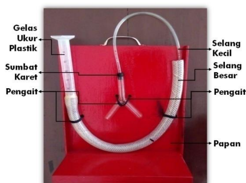
Gambar 1. KIT Praktikum Pengaruh Katalis Terhadap Laju Reaksi Secara Kuantitatif
