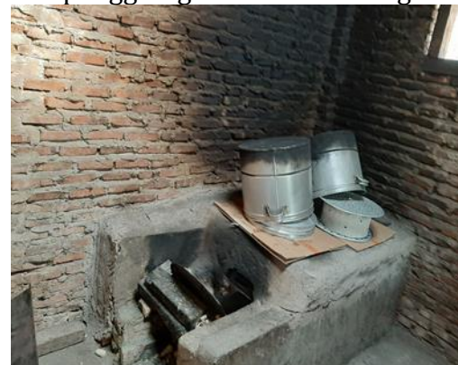
Gambar 4. Tungku Pengukus singkong parut
