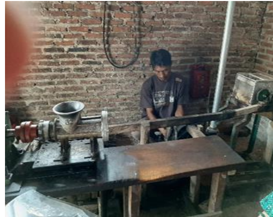
Gambar 2. Alat pamarut singkong dan penggiling adonan kelanting
