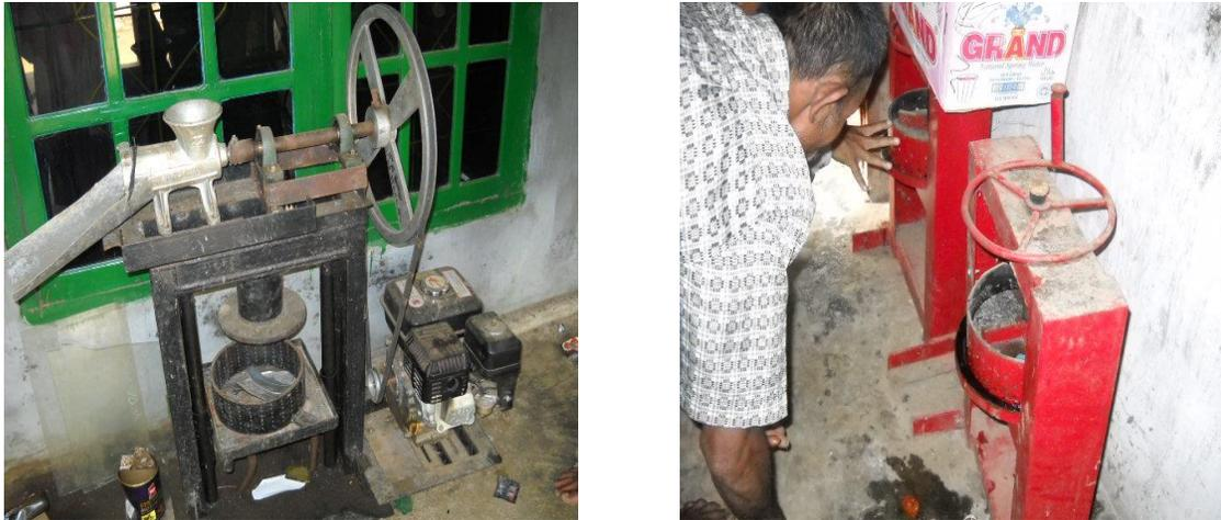
Gambar 15. Alat Pengepres Biji Jarak Pagar untuk Menghasilkan Minyak Jarak Pagar.
