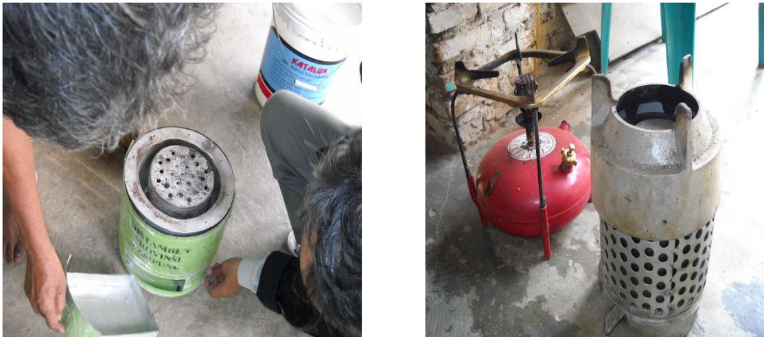
Gambar 14. Kompor Berbahan Baku Biji Jarak Pagar dan Minyak Jarak Pagar.
