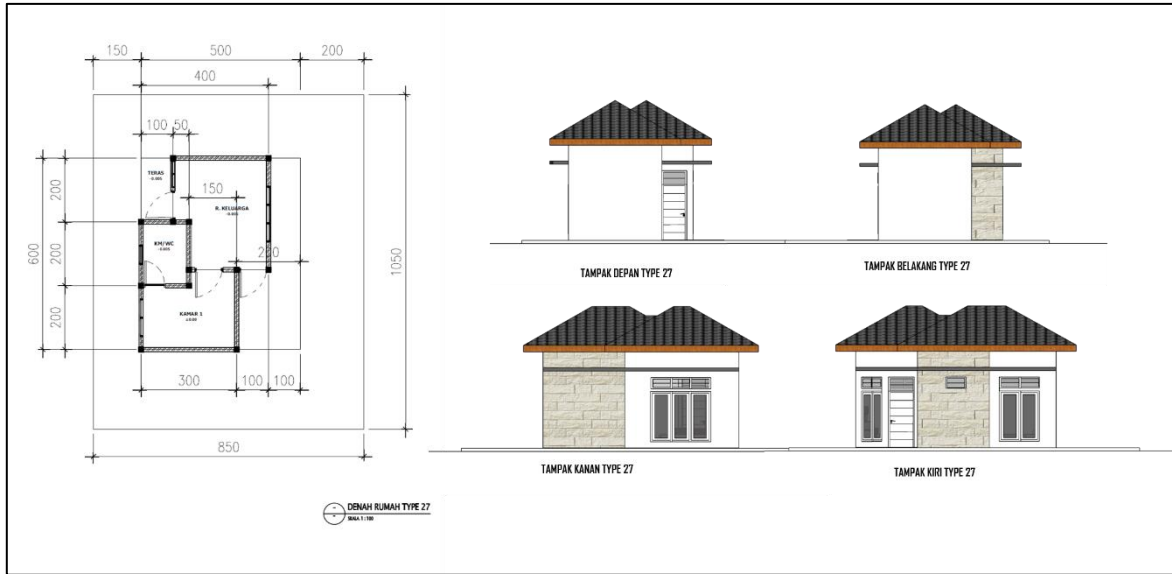
Gambar 4. Denah dan Tampak Desain Rumah Sehat Type 27
