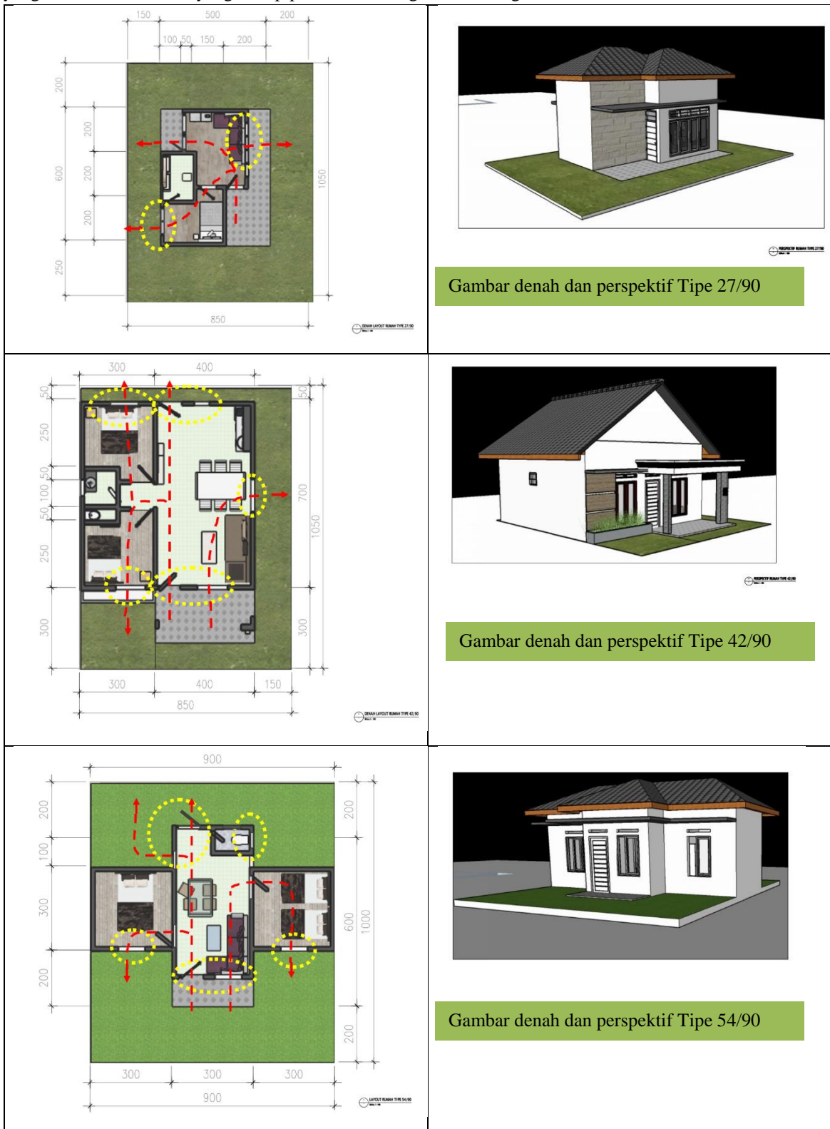
Gambar 3. Ilustrasi Sirkulasi Penghawaan pada Denah Rumah Sehat oleh Tim Pengabdian
