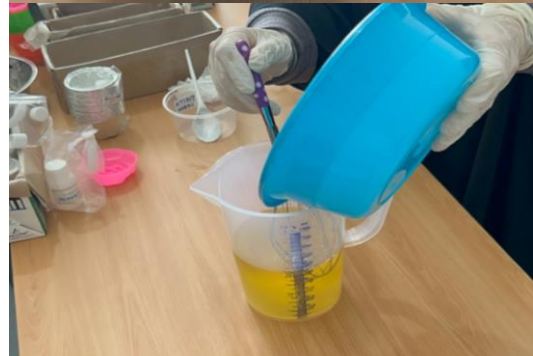
Gambar 3 Proses Pencampuran NaOH kedalam minyak jelantah
