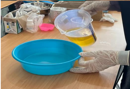
Gambar 3 Proses Pencampuran NaOH kedalam minyak jelantah
