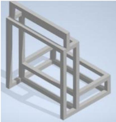
Gambar 4. Rancangan Rangka Media Pengombak.
