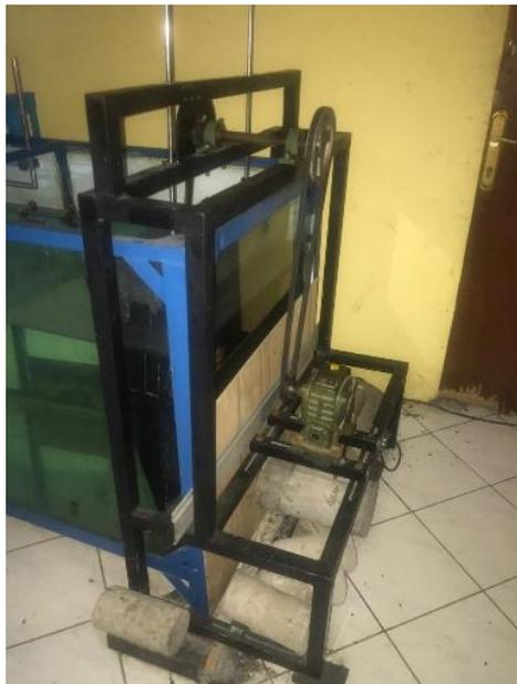
Gambar 5. Rangka media pembangkit gelombang
