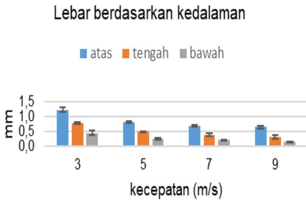
Gambar 4. Diagram hasil lebar berdasarkan kedalaman pemotongan
