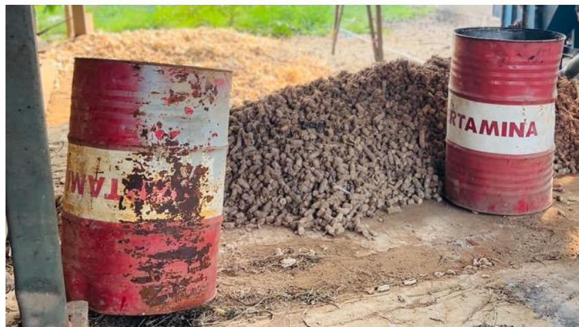
Gambar 3. Drum yang digunakan sebagai media pembuatan biochar
