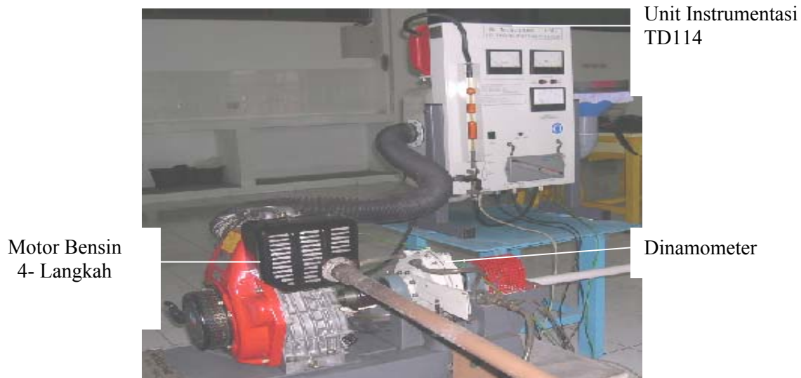
Gambar 1. Instalasi peralatan pengujian dan unit instrumentasi
