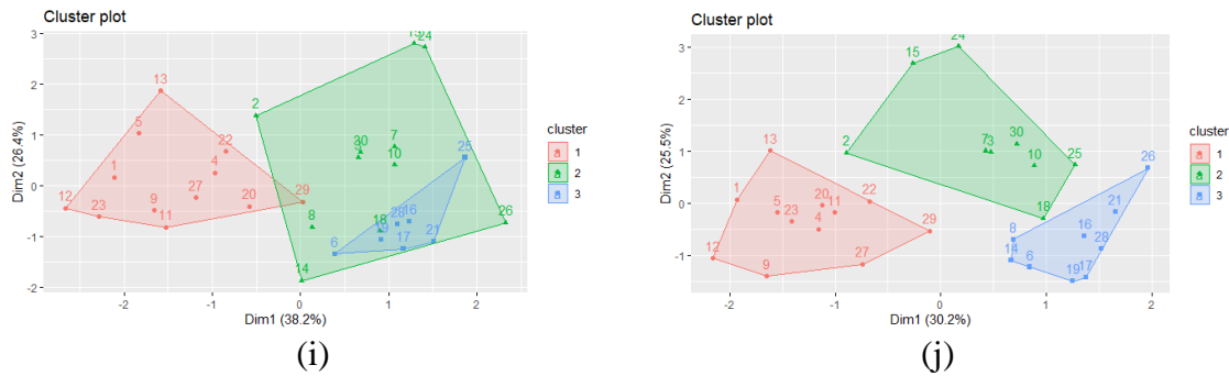
Gambar 5. Hasil Pengelompokan menggunakan metode K-Medoids pada saat kluster optimal sebanyak 3 kluster (i) untuk nilai negatif yang di nol kan (j) untuk nilai negatif yang di mutlakkan.
