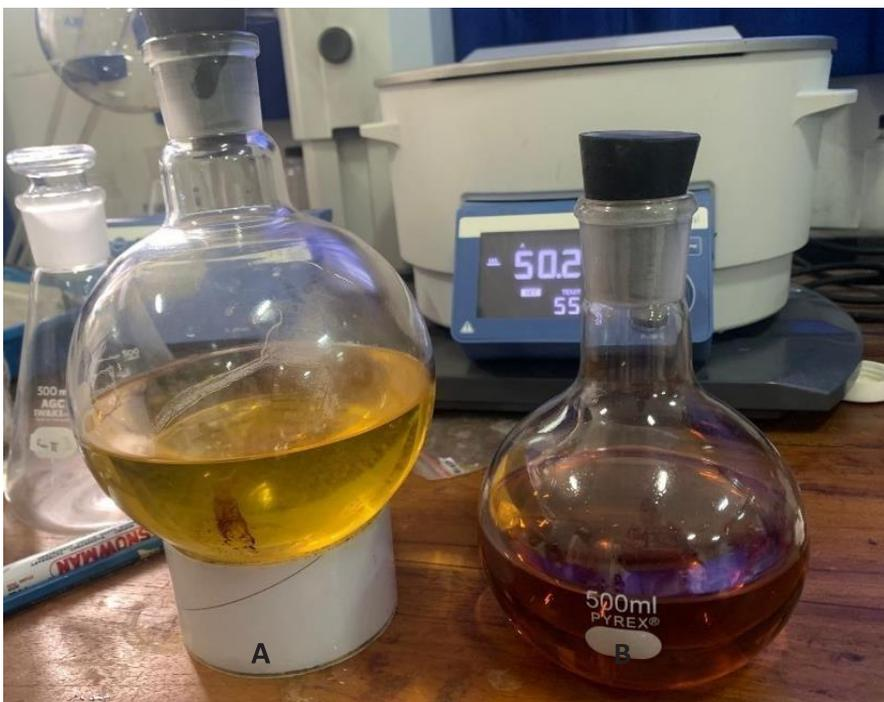
Gambar 12. Minyak residu hasil ekstraksi dengan metode sokletasi
