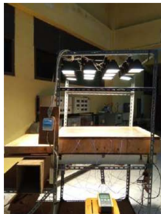
Gambar 2. Solar simulator sebagai representasi radiasi matahari
