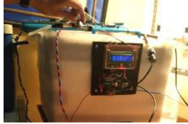
Gambar 3. Unit pemanas air sistem autocontrol
