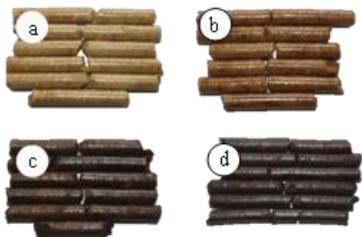
Gambar 1 Tampilan Visual Pelet Bambu Andong: (a) kontrol, (b) setelah torefaksi pada suhu: (b) 200°C, (c) 240°C, dan 280°C
