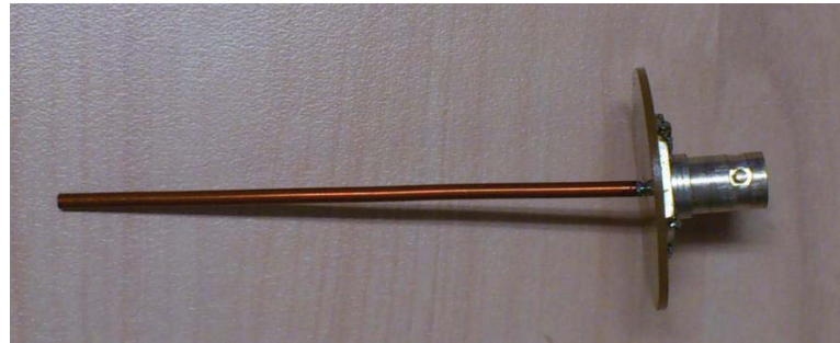
Gambar 2. Sensor monopole , panjang 10 cm
