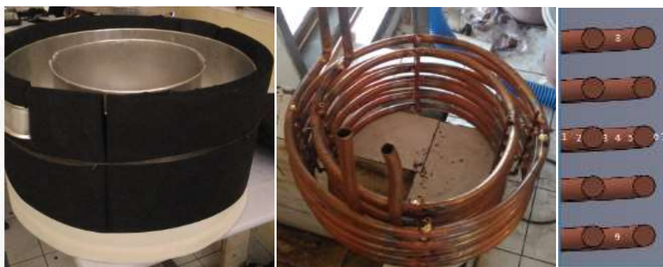
Gambar 2. Alat penukar kalor jenis koil dan posisi penempatan termokopel
