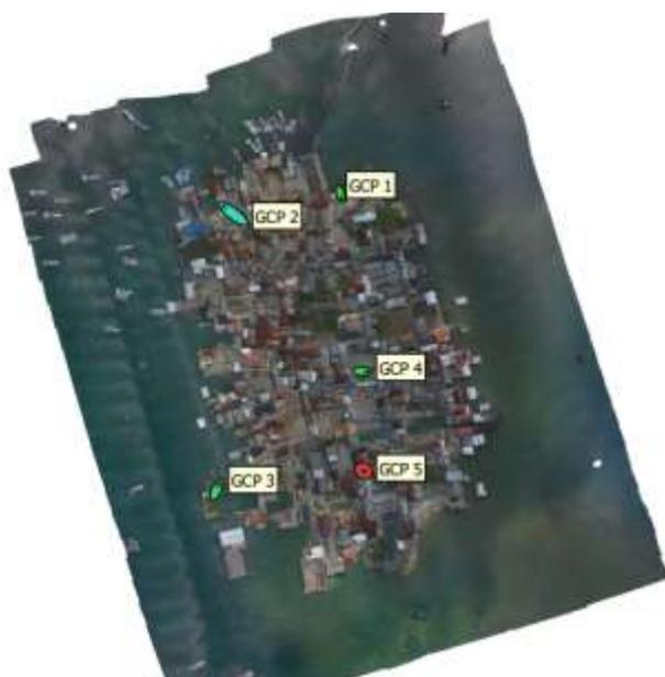
Gambar 5 Rencana Distribusi Titik Kontrol Tanah
