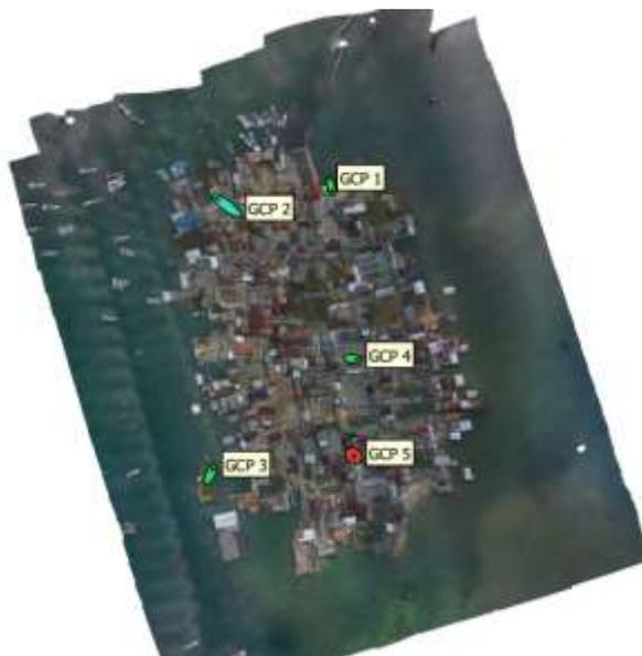
Gambar 9 Distribusi Titik Kontrol Tanah
