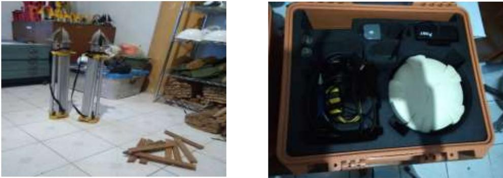
Gambar 6 Persiapan Alat (a) statip, (b) GPS Geodetik
