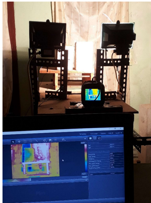
Gambar III.4 Setting uji thermography pada beton bertulang
