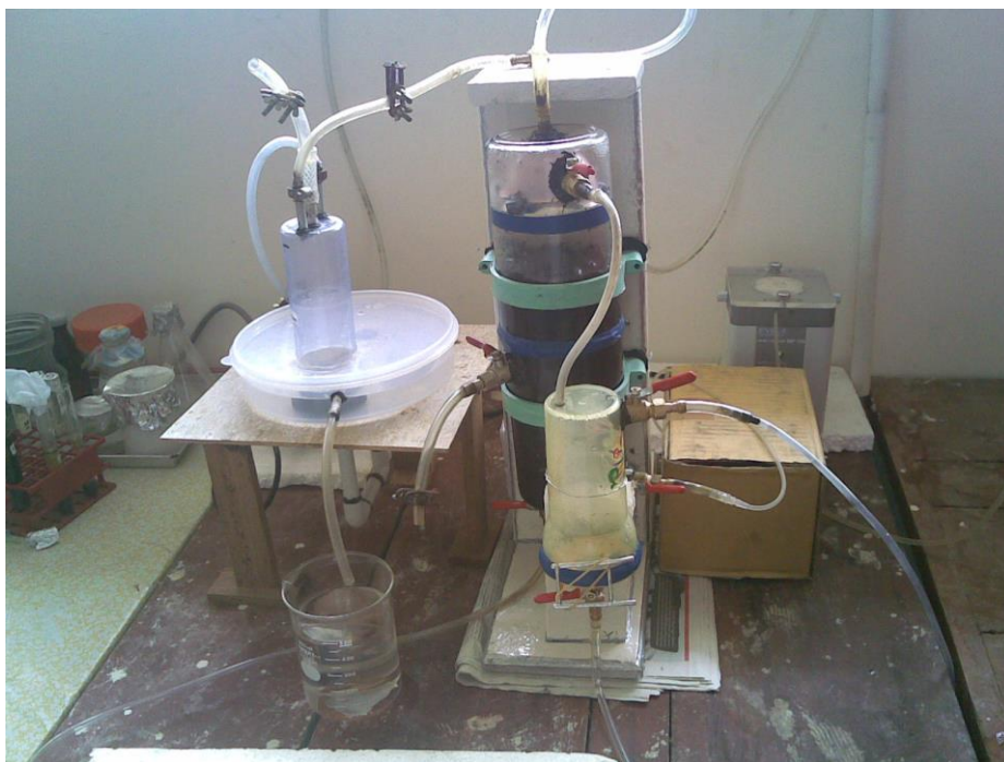
UNIT LENGKAP SISTEM BIOREAKTOR UASB
