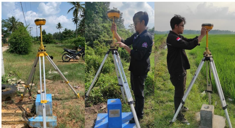
Gambar 3.5. Pengukuran titik BM Metode Statik Jaring.
