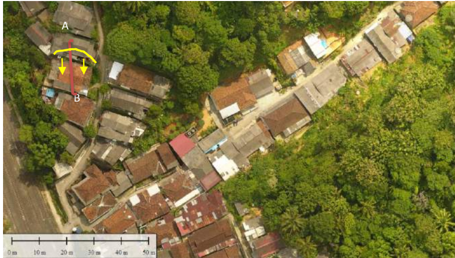
Gambar 13. Kondisi pembebanan lereng di Gg Sakal dari foto udara
