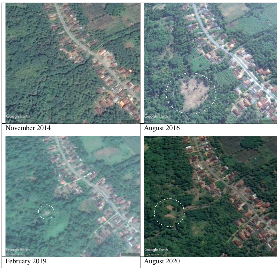
Gambar 4.3 Kondisi geomorphology sebelum dan setelah longsor
