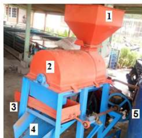
Gambar 1. Alat Penghancur Kotoran Kambing Tipe Basah
