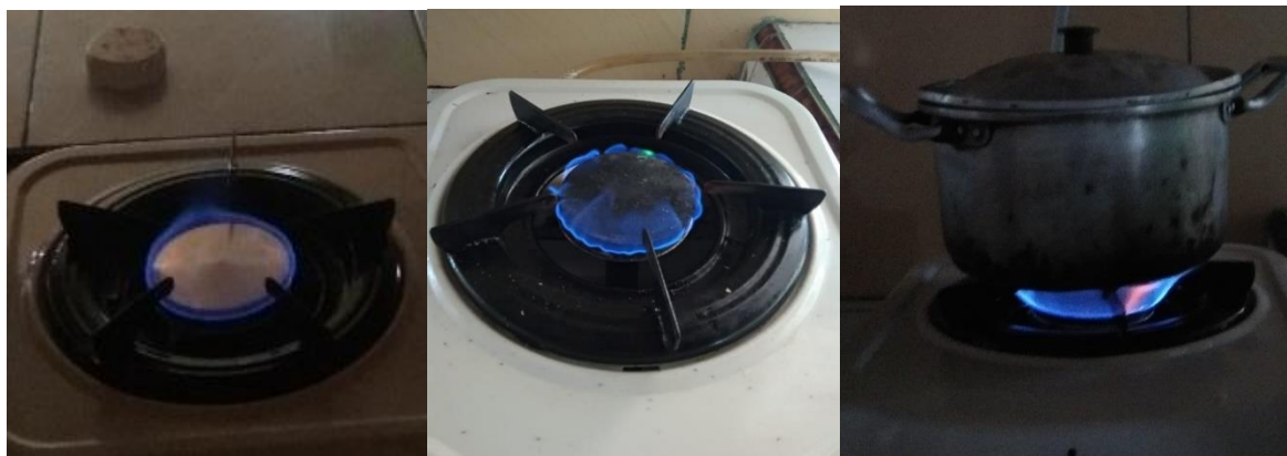
Gambar 5. Perkembangan kualitas biogas yang ditunjukkan oleh kualitas nyala api: hari ke-10 (kiri), hari ke-20 (tengah), dan hari ke-30 (kanan).
