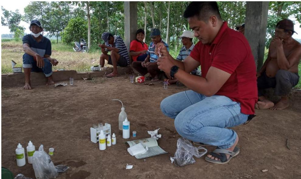
*Gambar 2.* Pengujian sampel tanah sawah dengan Perangkat Uji Tanah Sawah (PUTS).
