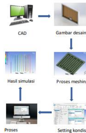
Gambar 4. Skema proses simulasi unjuk kerja kolektor PV/T
