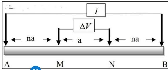
Gambar 1. Ilustrasi titik-titik pengukuran konfigurasi Wenner-Schlumberger [17].
