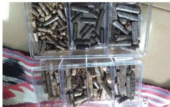
Gambar 6. Contoh Pellet Biomassa Dari Bagas Tebu, TKKS, Batang Singkong (Hasil Penelitian Tim Unila)
