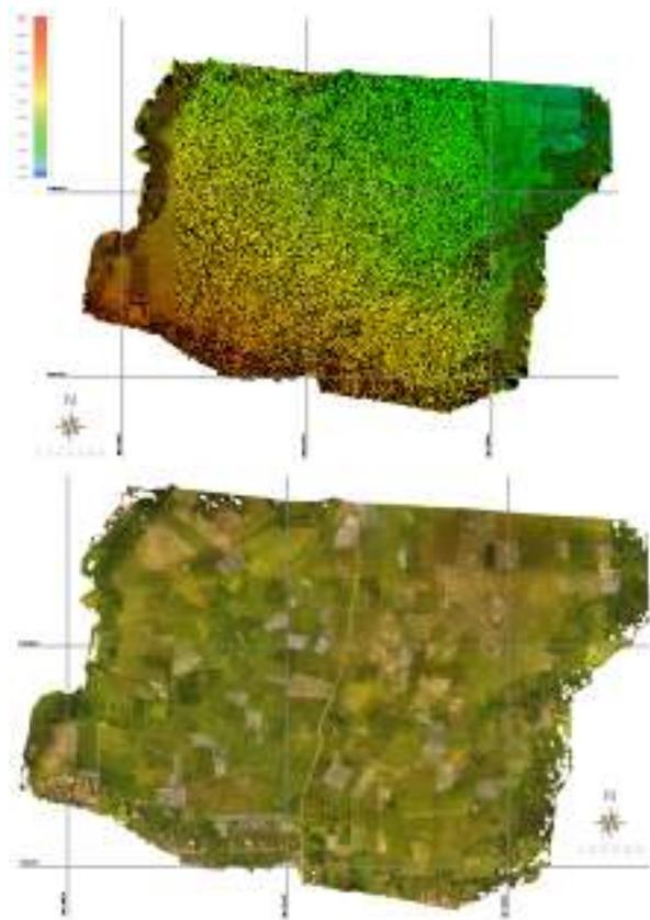
**Gambar 13.** Hasil peta DSM (atas) dan foto udara (bawah) dengan Drone di area Persawahan Pekon Dadapan.
