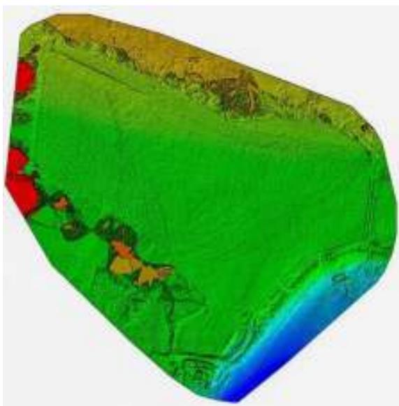
**Gambar 7.** Peta DSM yang menggambarkan topografi lahan dengan warna merah berupa ketinggian dan biru rendahan
