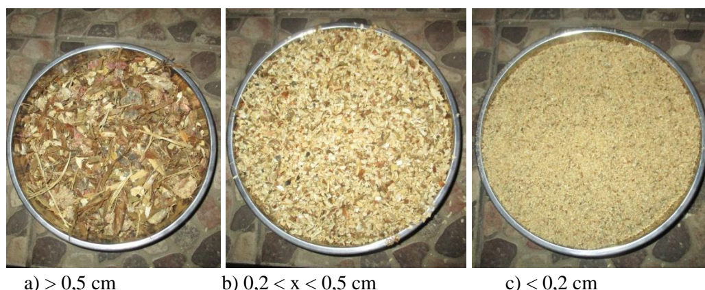
Gambar 8. Hasil ukuran cacahan alat perajang batang singkong
