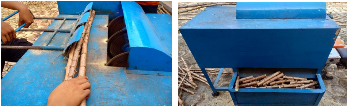
Gambar 1. Proses pengumpanan dan hasil pemotongan bibit singkong
