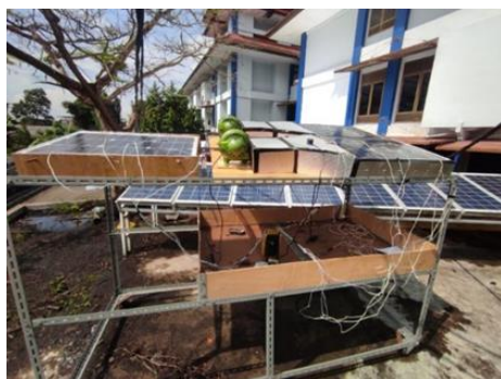
Gambar 5. Pengujian Photovoltaic/Thermal dengan sirip bersudut berdasarkan iklim Lampung
