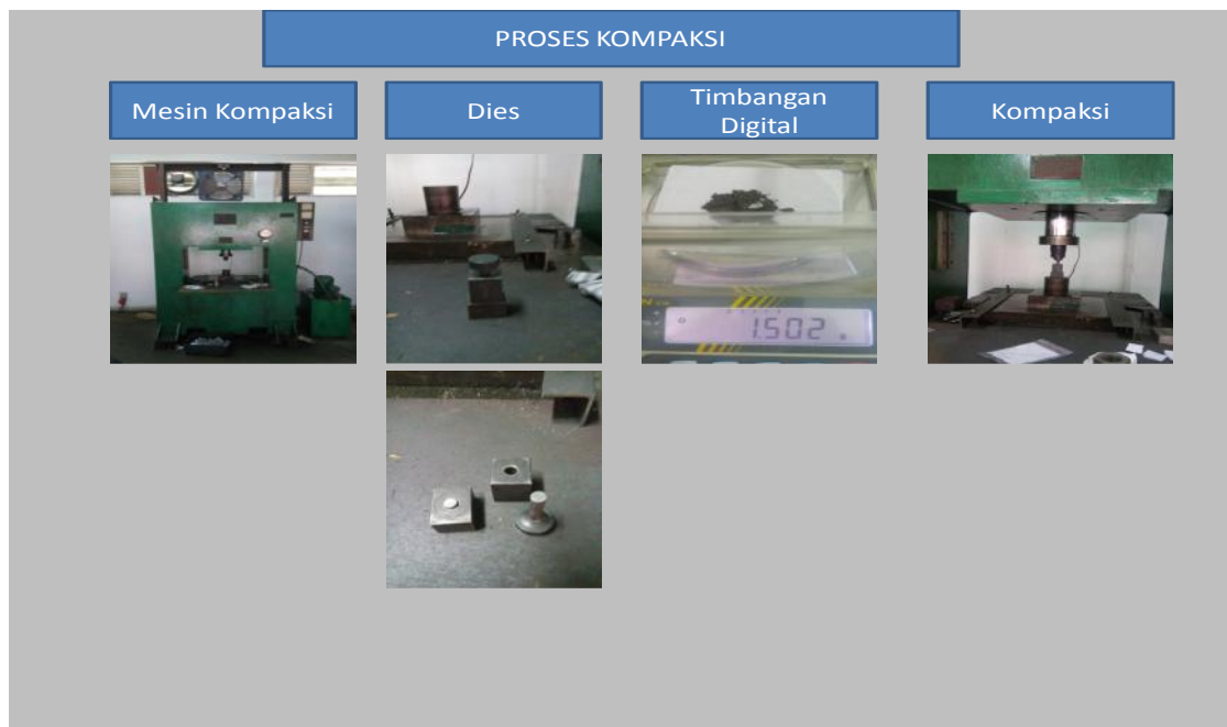
Gambar 6 Tahapan Proses Kompaksi
