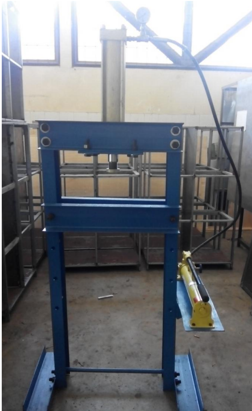
Gambar 20 Rakitan rangka dan pompa hidrolik mesin pompa
